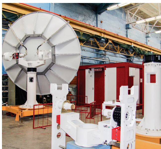
Антенная система «ДМРЛ-10» с безредукторными синхронными двигателями
