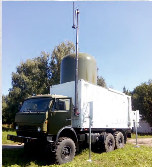
Малогабаритный метеорологический комплекс «КММ-1» предназначен для измерения параметров атмосферы при помощи аэрометрического зондирования до высот 40 км и автоматизированной метеорологической станции, а также наблюдения за явлениями погоды (в т.ч. опасными – гроза, град, шквал) в радиусе до
