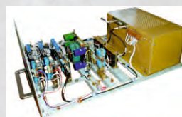
Модули твердотельного модулятора и высоковольтного источника питания
