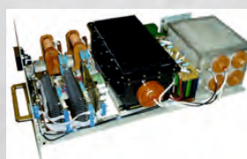
Модули твердотельного модулятора и высоковольтного источника питания
