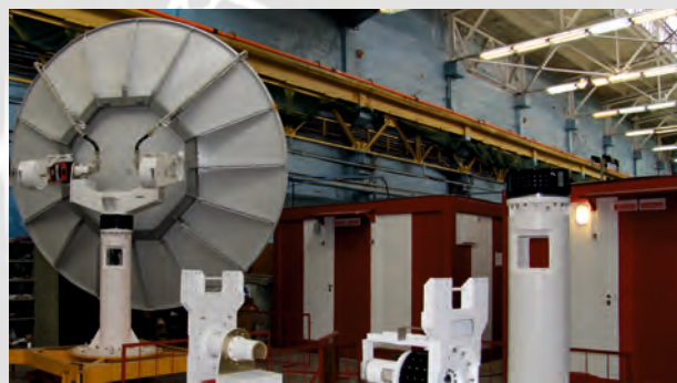
Антенная система «ДМРЛ-10» с безредукторными синхронными двигателями
