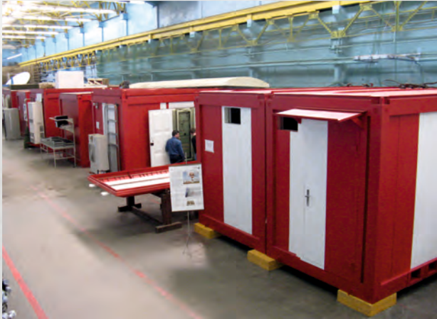
Поточная линия сборки АРЛК «Лира-А10»
